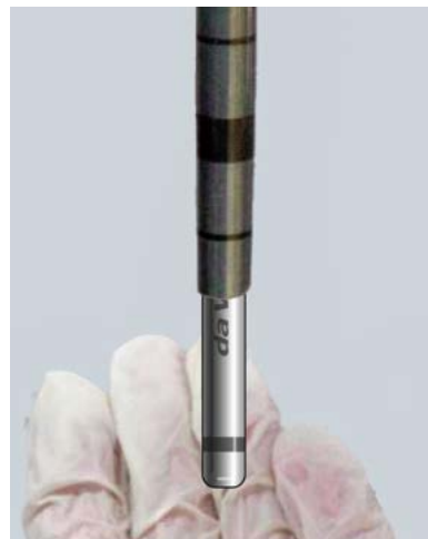
Uszkodzona – wałeczek pomiarowy nie przechodzi przez kaniulę
