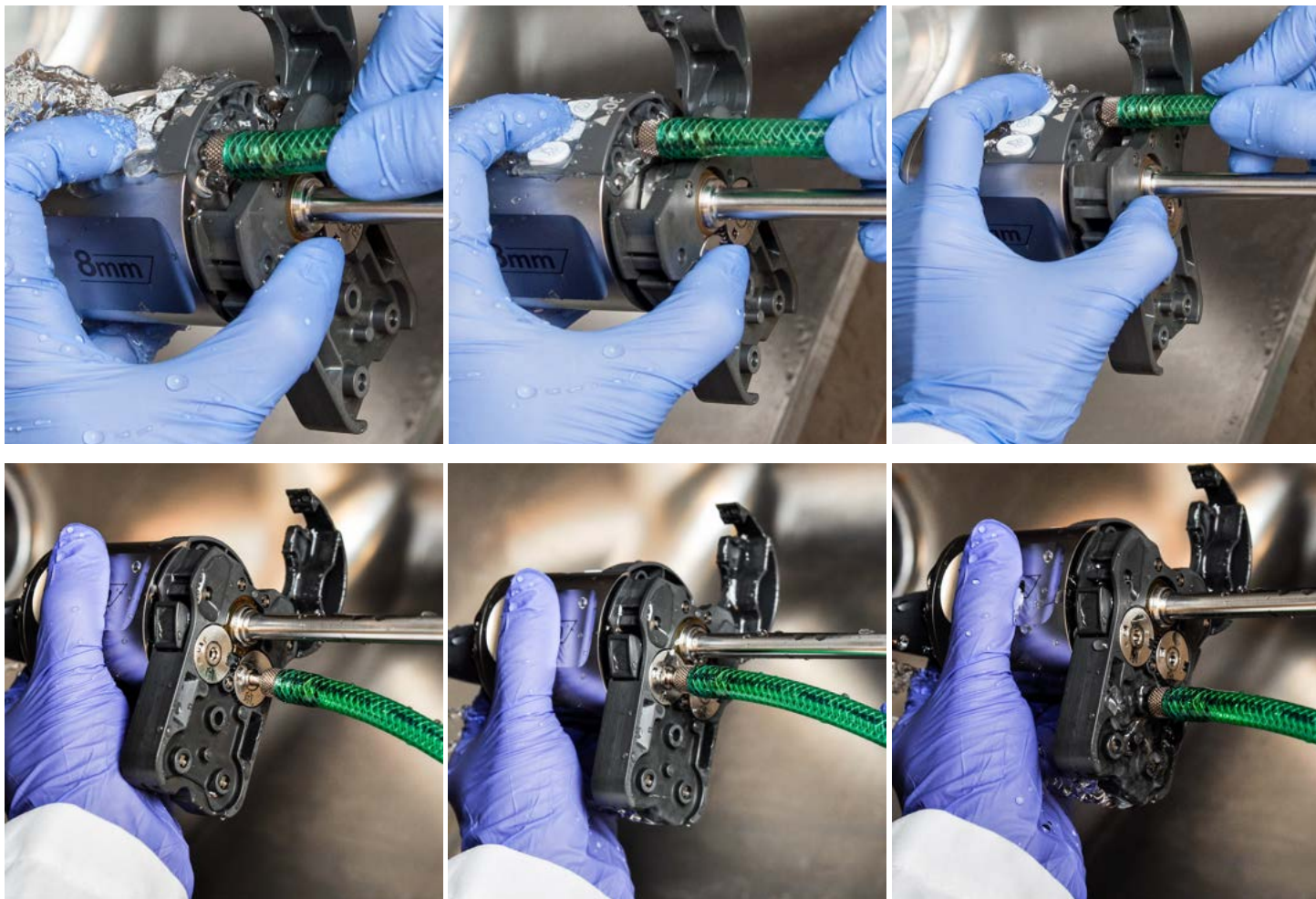
Płukać każdy z portów płukania i otworów w dwóch krążkach wejściowych przez 20 sekund
