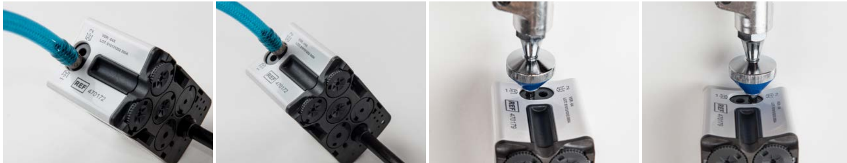
Przepłukać każdy port płukania zimną wodą, używając złącza Luer dostarczonego przez firmę Intuitive Surgical lub pistoletu wodnego z identycznym złączem Luer.
